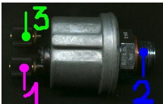
Le repère 1 (sur la sonde il y a écrit "WK")est l'endroit ou l'on branche le fils d'alerte de pression d'huile, récupéré lors du montage de la sonde de température d'huile (il faut couper la cosse d'origine et mettre une cosse avec un trous.)
