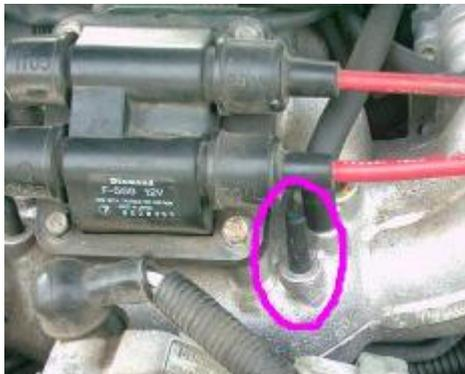
La durite de pression de turbo se branche sur le collecteur d'admission à la place du bouchon.
