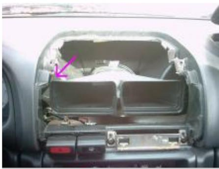
Le plus simple pour passer les fils et la durite de turbo de l’habitacle vers le moteur, est de faire passer du côté du conducteur.
