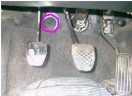
Une fois en bas il faut passer par-dessus la colonne de direction, percer la pastille de caoutchouc (entre la pédale de frein et la pédale d’embrayage) et passer à travers de cette pastille.
