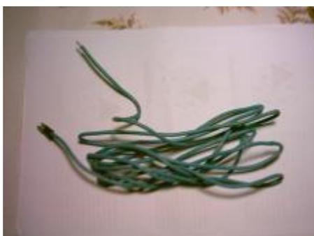
Fils pour le branchement de la sonde de température d'huile.
